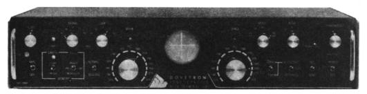
THE MPC-1000R REGENERATIVE RTTY TERMINAL UNIT
