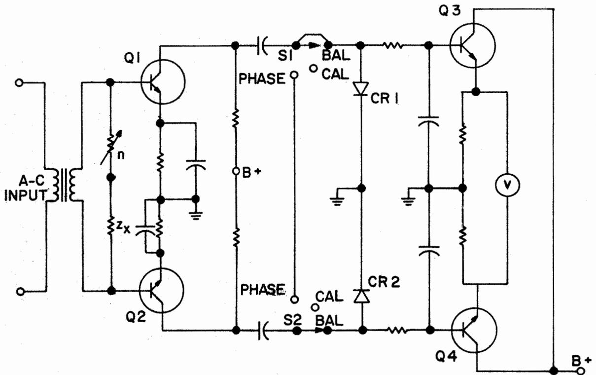
Figure 2-20. Impedance-Angle Meter
