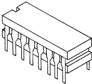
Figure 2-114. DIP-Type IC
