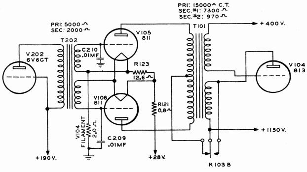
Fig. 17 Modulator Circuits (Dwg. No. 500 0223 00A)
