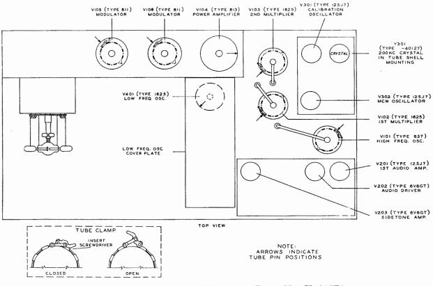
Fig. 29 Tube Placement Diagram (Dwg. No. K1627B)
