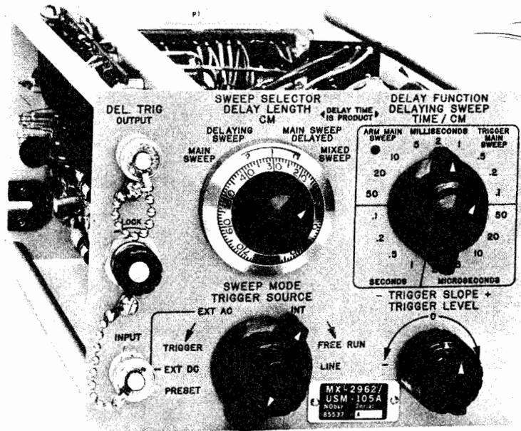
OSCILLOSCOPE SUBASSEMBLY, HORIZONTAL CHANNEL, VARIABLE TIME DELAY
