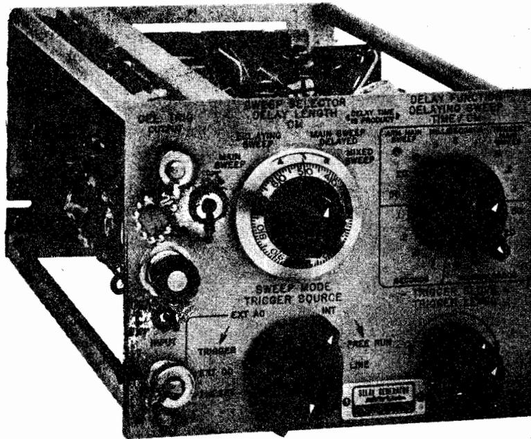
OSCILLOSCOPE SUBASSEMBLY HORIZONTAL CHANNEL, VARIABLE TIME DELAY MX-2962A/USM
