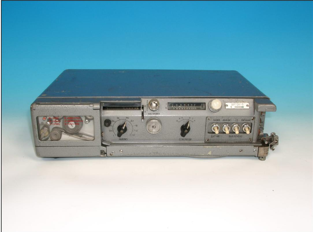
Argon-B: Streifenschreiber zur Analyse von Fernschreibsignalen für Geschwindigkeiten zwischen 42 und 86 Baud.
