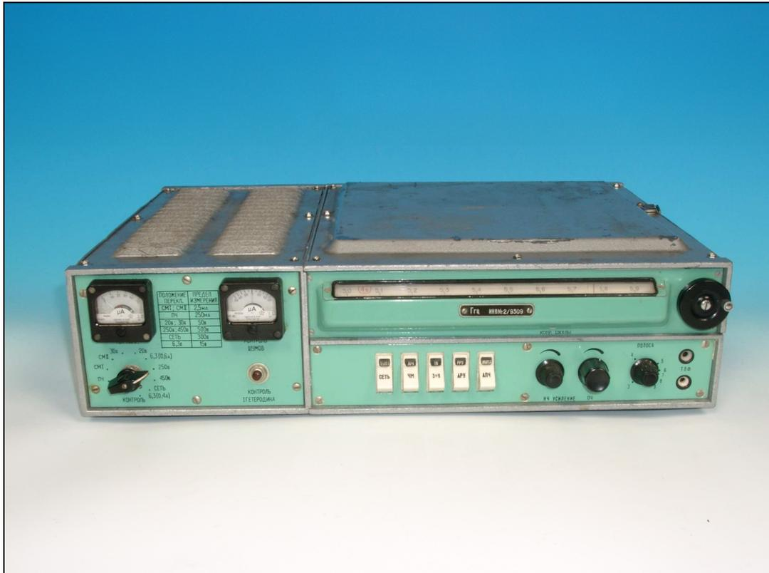
Ein russischer Mikrowellenempfänger „Krypton P-4a“ für das 5GHz-Band, der von den Spezialfunkdiensten der HA III zur Funkaufklärung von RiFu verwendet worden ist.
